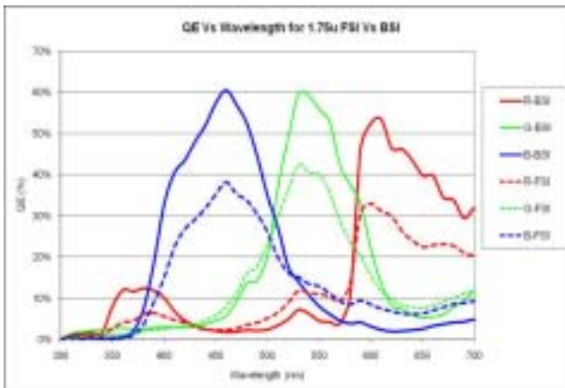
Fig.11: QE for 1.75um FSI vs BSI.
